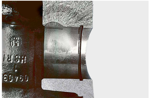
Rys. 3: Przekrój piasty sworznia tłokowego
